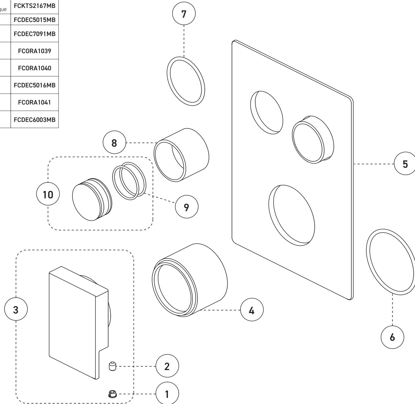
Valve - Trim for Thermostatic 2-way Diverter Valve (D/B) - Valve - Garniture pour valve thermostatique, déviateur 2 voies (D/B)
